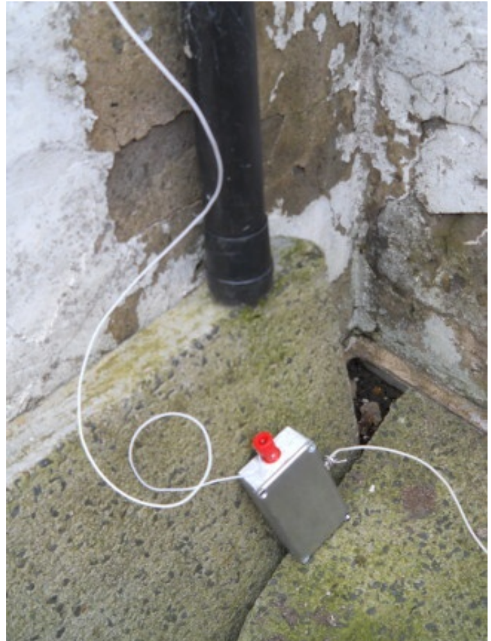
Afsluitpunt met 390Ω weerstand Termination point with 390Ω resistor
