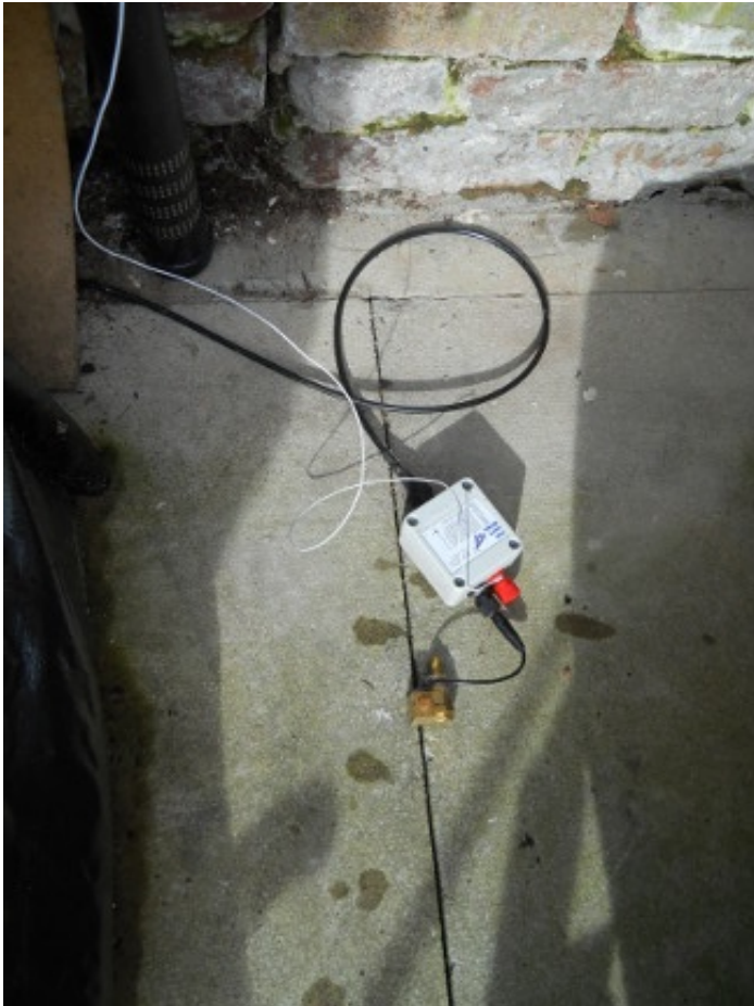
Voedingspunt met de 9:1 balun Feeding point with the 9:1 balun
